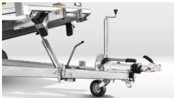
Roue jockey automatique pour replier la roue simplement et rapidement par manivelle.
