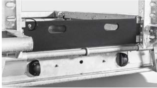
Panneau enfichable pour sécuriser la surface de chargement (seulement sur les modèles AS).
