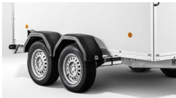
Essieu à suspension individuelle en caoutchouc, sans entretien pour un excellent confort de route.
